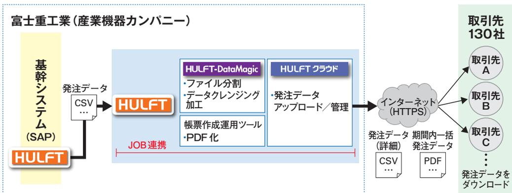
HULFT および HULFTクラウドを軸にした Web発注システムの仕組み HULFT 経由で基幹系から取り込まれた発注データをもとに、HULFT-DataMagicでファイル分割とクレンジング加工が行われ、サードパーティの帳票作成・運用ツールで確認用帳票の PDF ファイルが生成される。この処理は JOB 連携により、自動で実行される。取引先は Web ブラウザから HULFTクラウドに接続し、PDF ファイルと発注単位の CSV ファイルを入手する。
